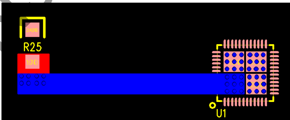
图 27 无线充采样电阻走线
